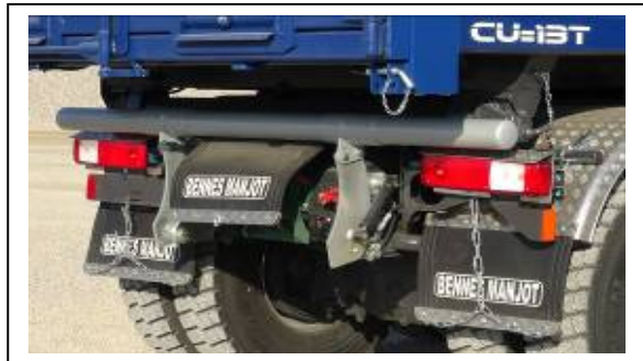
5 – Nouvelle barre anti-encastrement à grand débattement
