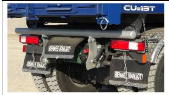
5 – Nouvelle barre anti-encastrement à grand débattement
