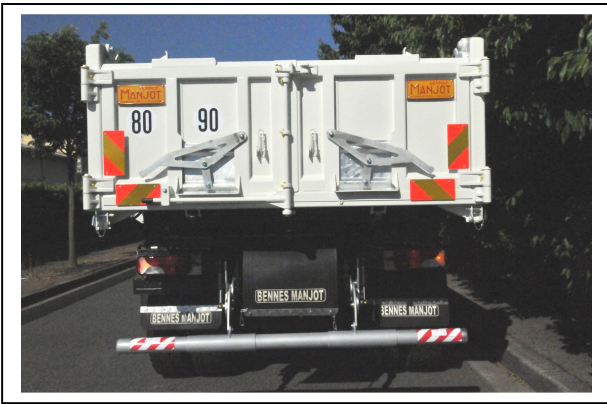
3 – Nouveau design de porte , Nouveaux portillons charbonnier
