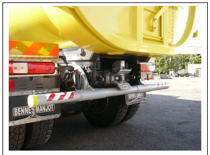
5 – Compatibilité au finisseur avec barre anti-encastrement appropriée
