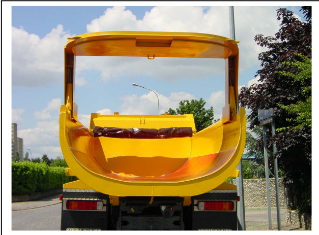
1 – Corps de caisse elliptique , porte hydraulique à grand passage
