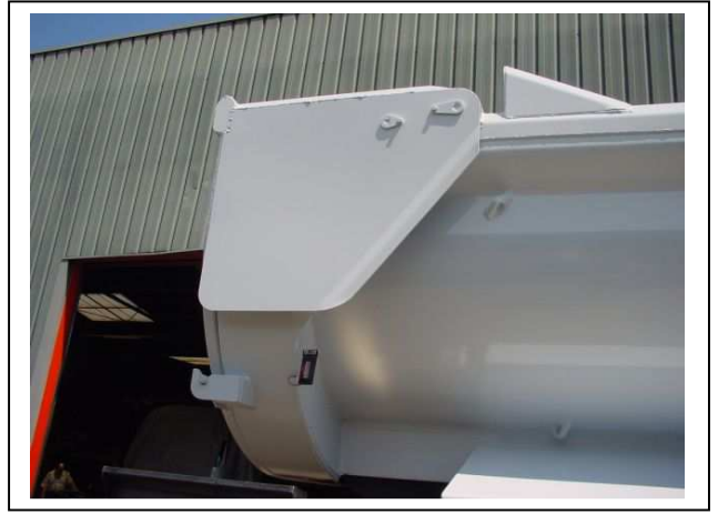
2 – Vérins de porte hydrauliques protégés, fermeture type « guillotine »
